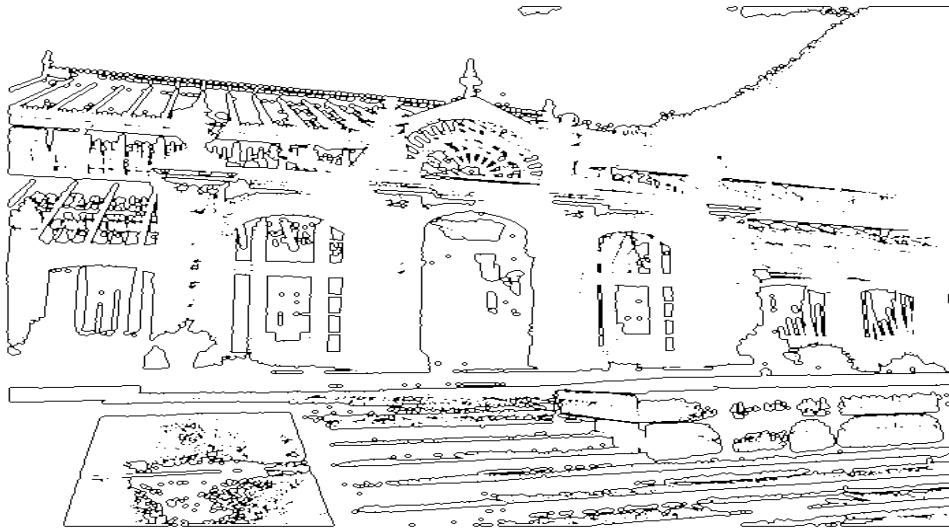
Abbildung 3.10: Ergebnis des im Rahmen dieser Arbeit entwickelten Operators (invertiert): a) Ein gutes Rauschverhalten b) Genaue Konturpunktlokalisierung (meistens nur ein Pixel breite Konturen)
