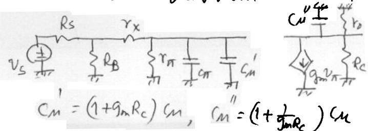
3.8.3 (contd.) (d) pole freq. due to  $C_{\pi} + C_{\mu}' \rightarrow \frac{1}{(C_{\pi} + C_{\mu}') \cdot R_X}$
