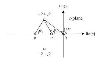
$\varphi_z - \varphi_p - 135^\circ - 135^\circ = 180^\circ \Rightarrow \varphi_z - \varphi_p = 90^\circ$
