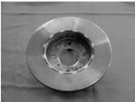
Fig. 3.22 Aluminum-MMC brake disk
