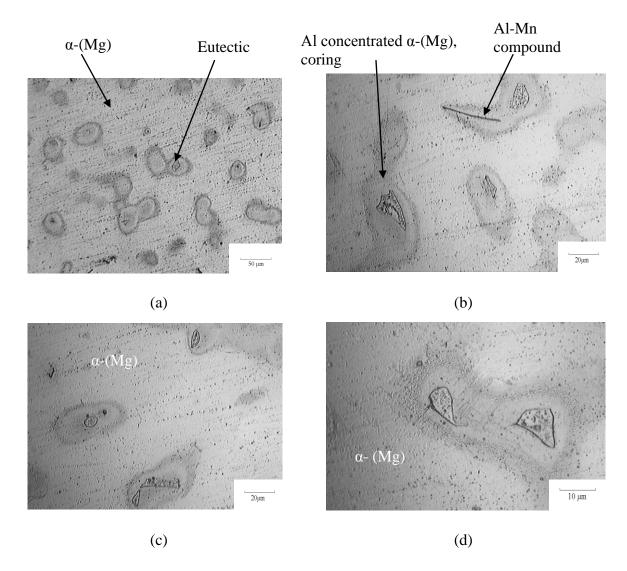
Figure 44: As-cast microstructure of AM60B: (a)100X (b) 500X (c) 500X (d) 1000X
